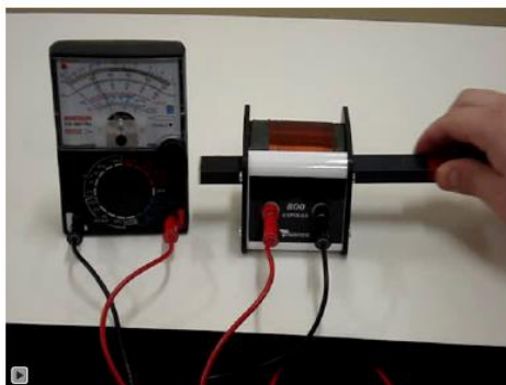
Vídeo 6.1: O movimento de um ímã em relação a uma bobina gera corrente elétrica induzida, medida através de um amperímetro, com o zero da escala na parte esquerda do visor.
