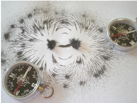
Figura 1.11: A distribuição das limalhas de ferro e a orientação da agulha magnética das bússolas evidenciam seus alinhamentos com a direção do campo magnético.
