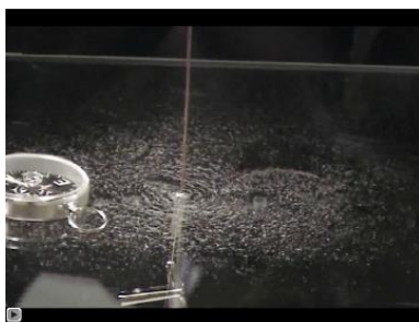
Vídeo 2.1: Demonstração das linhas de campo magnético ao redor de fio retilíneo.
