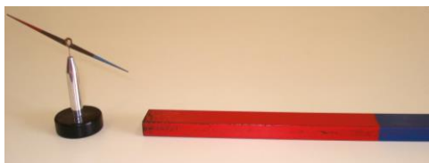
Figura 1.4: A fotografia mostra o polo norte do ímã em barra atraindo o polo sul e repelindo o polo norte da agulha magnética.
